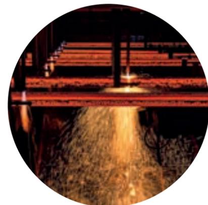
Восьмиручьевая машина непрерывного литья заготовок позволяет разливать металл без остановок на переналадку
